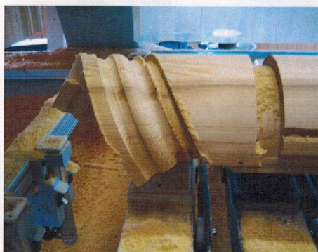
CNC-Bearbeitung eines 180°-Krümmlings: Voraussetzung für das Nutzen dieser neuen Funktion ist eine 5-Achs-CNC-Maschine mit ausreichender Bearbeitungshöhe in Z-Richtung
