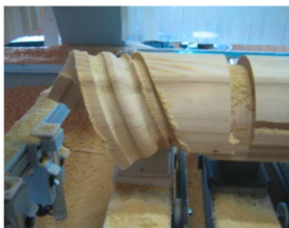
CNC-Fertigung eines 180-Grad-Krümmlings.
