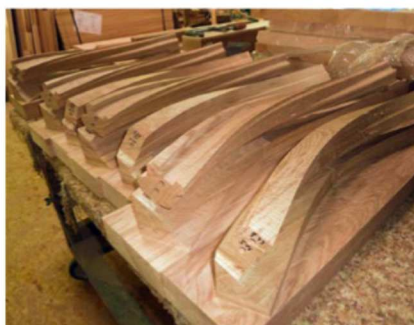
CNC-Fertigung verschiedener Krümmlinge.
